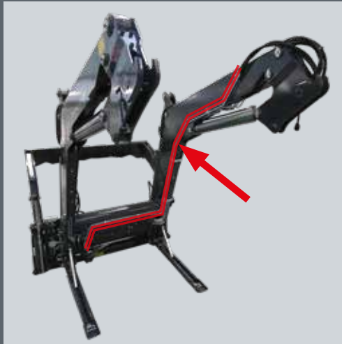
Pose de tuyaux pour REAL3 rd
